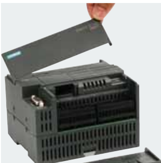
卸掉端子盖板
