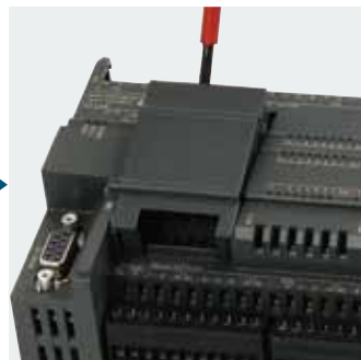
用螺丝刀卸掉空盖板
