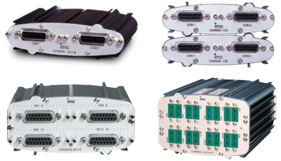
标准型CANSAS 轻巧，可堆叠 宽x高x长 35x111x90mm / 重量 300g(上图) 宽x高x长 55x111x90mm / 重量 560g(下图)
