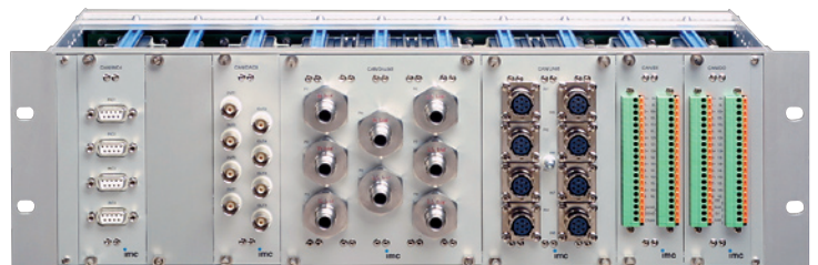
机架型 CANSAS-K 可搭配19" CANSAS RACK 机箱
