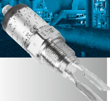
LFV 是通用型液位开关，它们可以在液体系统中精确（毫米级）检测到预先设定的液位。当容器内的液位超过允许的最大填充液位时，LFV 会发送填满信号给系统以防止过量填充导致的溢出；发送空罐信号给系统提示重新装载物料，以防止空罐运行，有利于保护泵工作在正常工作状态。LFV 可靠的设计以及坚固的外壳使得其工作时无机械磨损，免维护。
